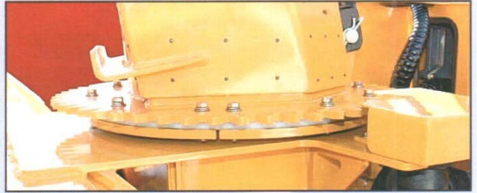
Système de rotation par moteur hydraulique et engrenage. Ce système robuste utilise deux matériaux différents, acier et thermoplastique UHMW, pour prévenir la friction et l'usure.
