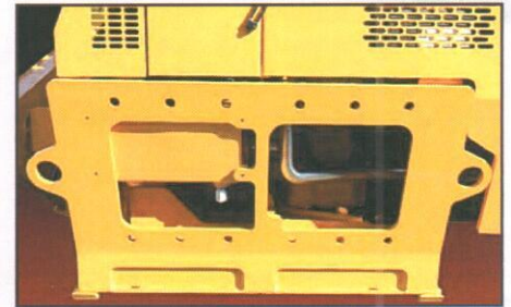
Plaque pour attache rapide pouvant être soudée ou boulonnée.
