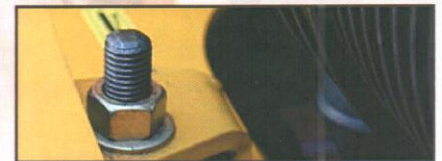
Ajustement de la tension de la courroie primaire du ventilateur.
