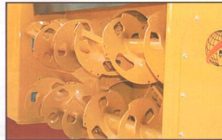
Vis percées pour l'ajout de brise glace boulonnés offerts en option.
