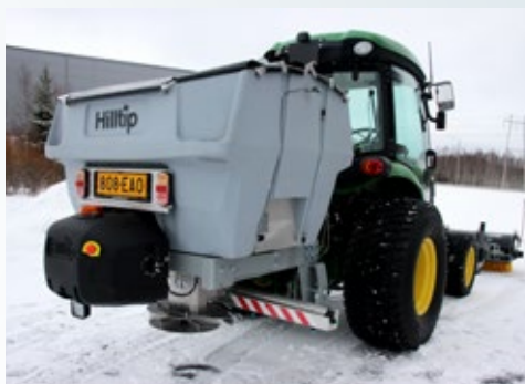
Épandeur avec attelage 3 points et barre de pulvérisation en option.
